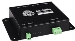
Le MOS-LED-IP est un contrôleur de bande LED standard. Conçu spécialement pour une utilisation studio et radio il permet de déclencher ON AIR avec commutations automatiques sur le fader, l'appel téléphonique entrant , l'alarme , e.t.c
